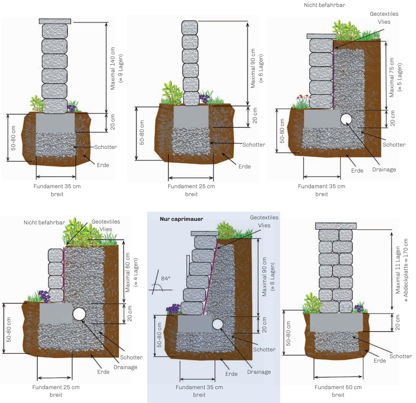
Falls man eine Stützmauer bauen will, darf man die Mauer nicht höher als 1 m aufbauen. Die Mauer darf nur geringen äußeren Belastungen ausgesetzt sein (waagerecher Abhang und geringe Belastung).
